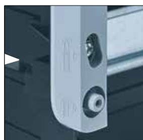
3 IDENTIFICATION DES VIS Marquage qui permet de repérer les vis à utiliser : • vis longues : châssis • vis courtes : plastron. Compatibles avec tournevis plat ou cruciforme.
